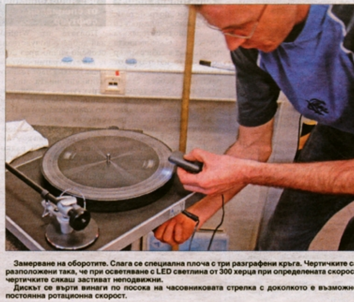
Замерване на оборотите. Сяга се специална плоча с три разграфени кръга. Чертичките са разположени така, че при осветяване с LED светлина от 300 херца при определената скорост чертичките сякаш застават неподвижни. Дискът се върти винаги по посока на часовниковата стрелка с доколкото е възможно постоянна ротационна скорост.
